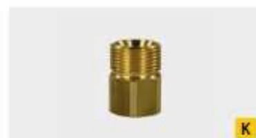
M22 M : F. Brass. Max. 400 bar
