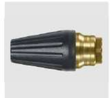
1/4" F. Spray angle 20°. 200 - 400 bar. Max. 100 °C
